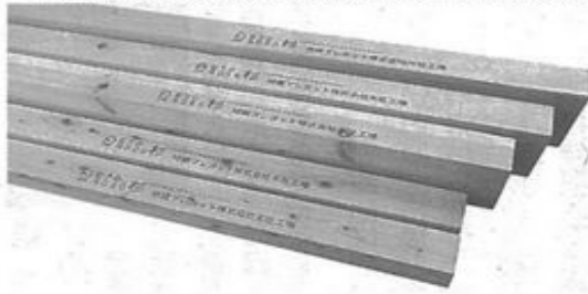
球磨プレカットで機械等級構造用製材のJAS格付けをする
